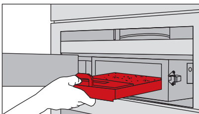
Abb. 5.4: Entnahme der Katalysator-Platte
